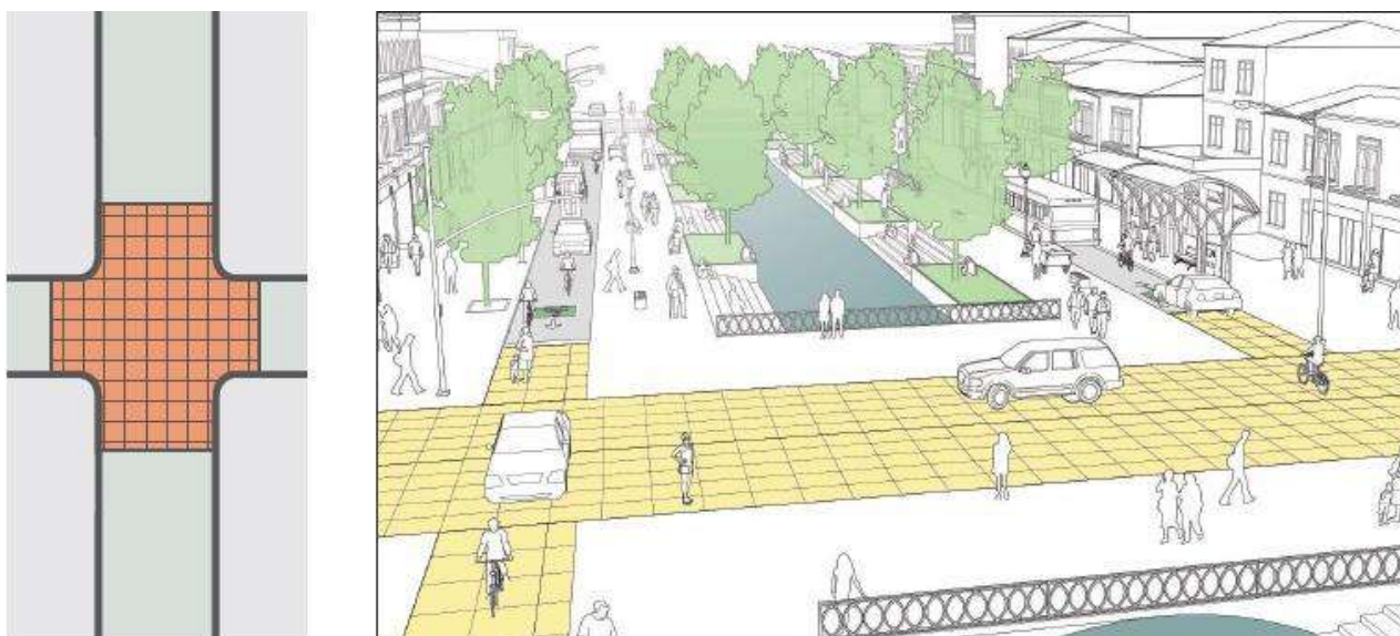
Figura 51 - Possibili interventi di moderazione del traffico - materiali e aspetto della pavimentazione (fonte: Global Street Design Guide)
