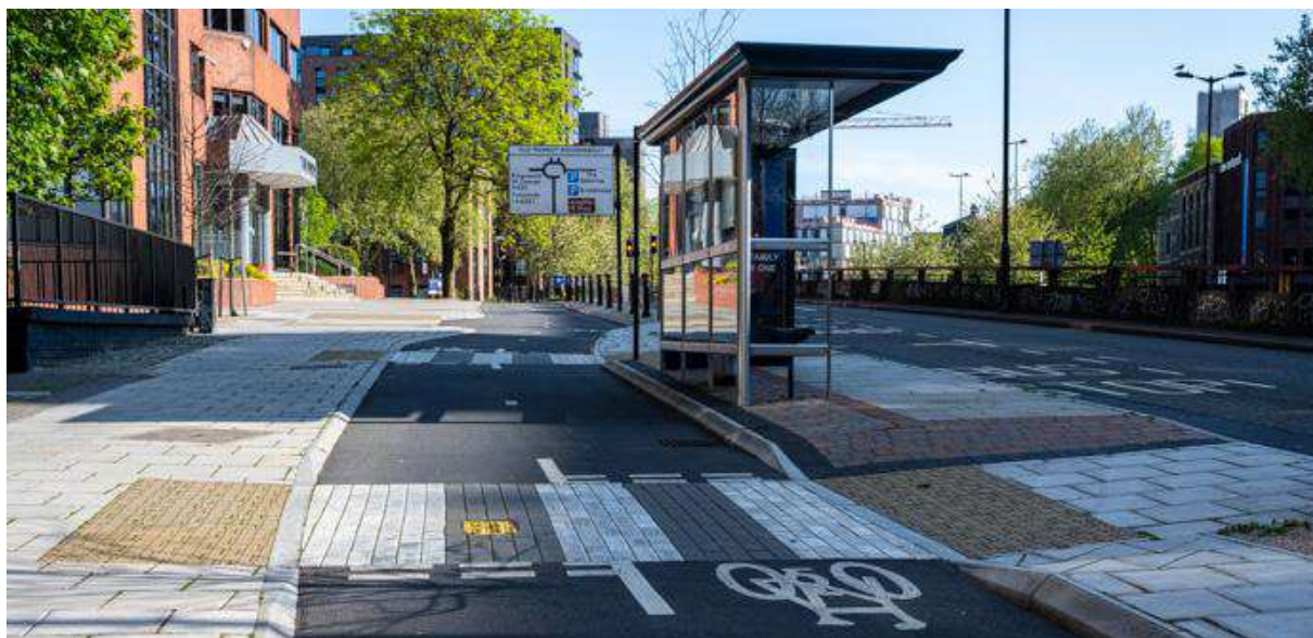
Figura 89 - Esempio di fermata con pensilina, con percorso ciclabile
