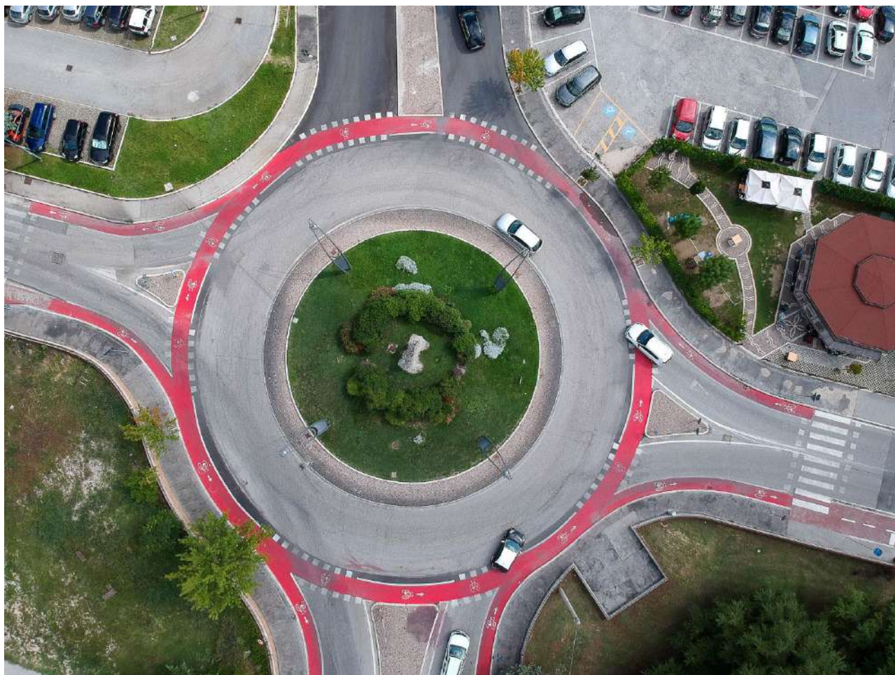
Figura 83 - Rotatorie ciclabili e attraversamenti sopraelevati
