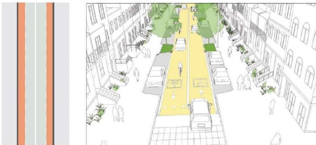
Figura 39 - Possibili interventi di moderazione del traffico - restringimento delle corsie (fonte: Global Street Design Guide)
