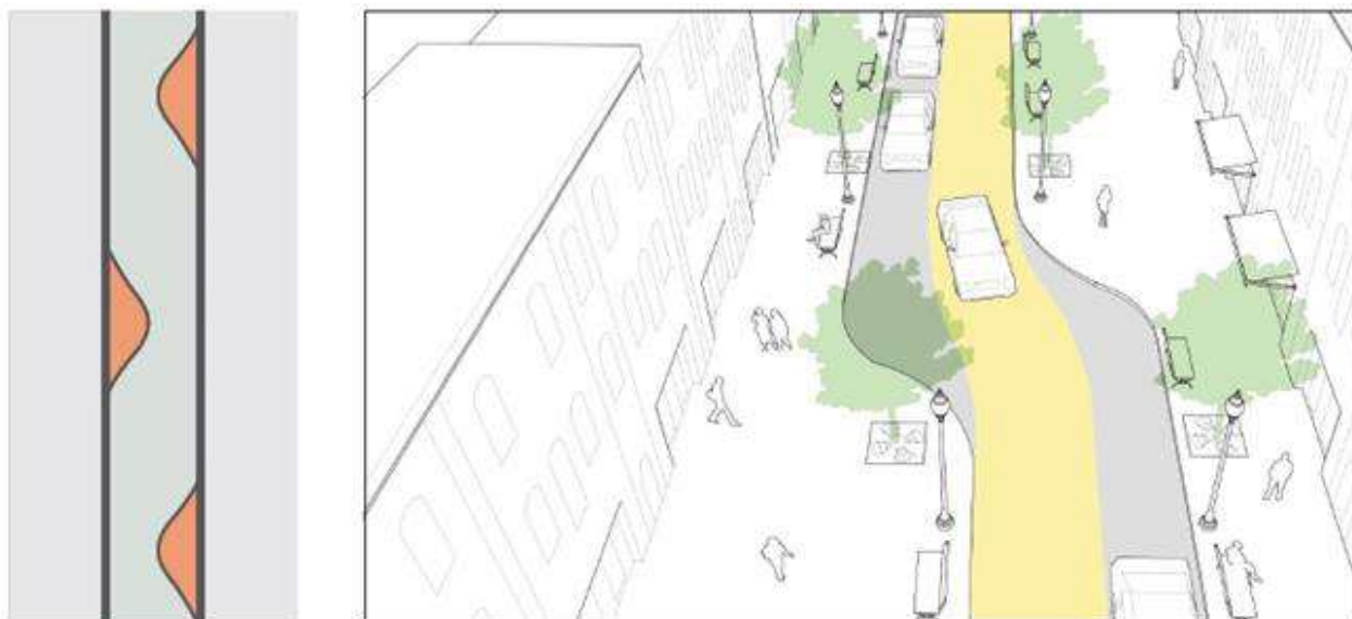
Figura 44 - Possibili interventi di moderazione del traffico - Chicane e disassamenti (fonte: Global Street Design Guide)
