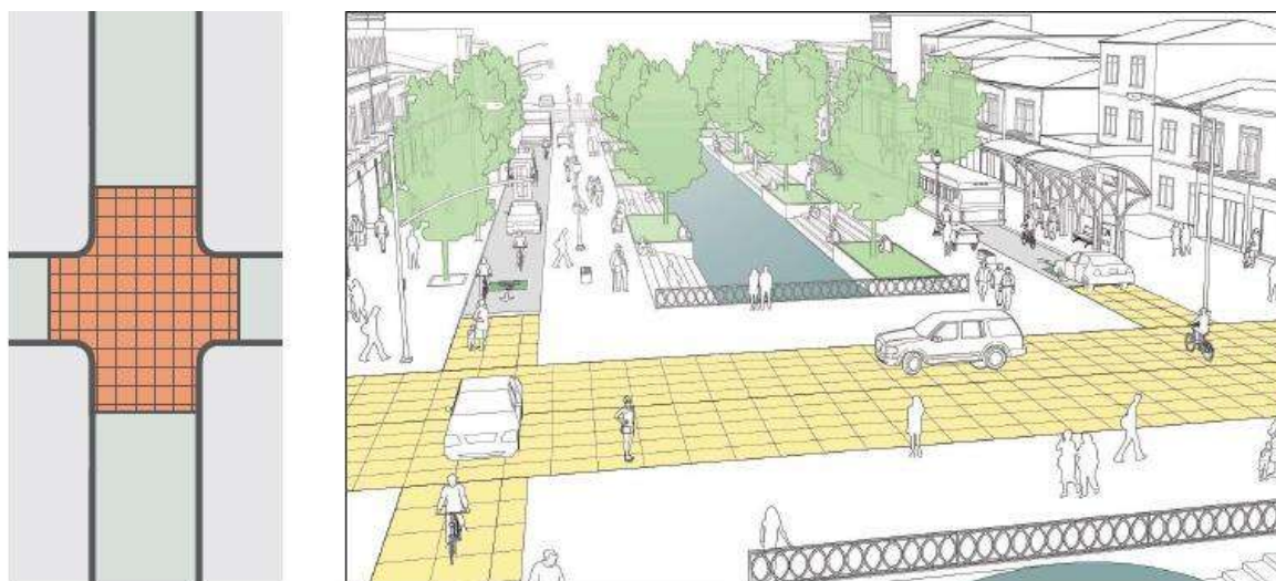
Figura 40 - Possibili interventi di moderazione del traffico - materiali e aspetto della pavimentazione (fonte: Global Street Design Guide)
